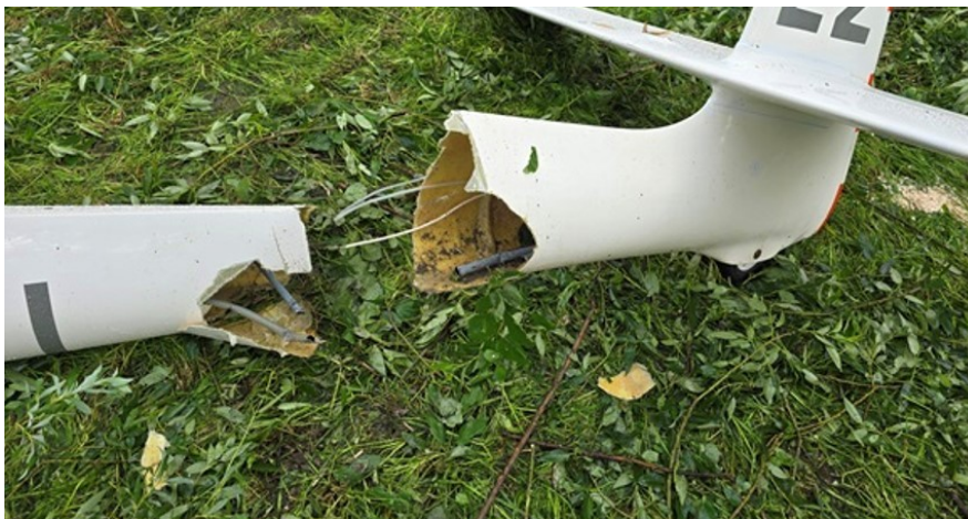
Abbildung 10 Rumpfröhrenbruch
