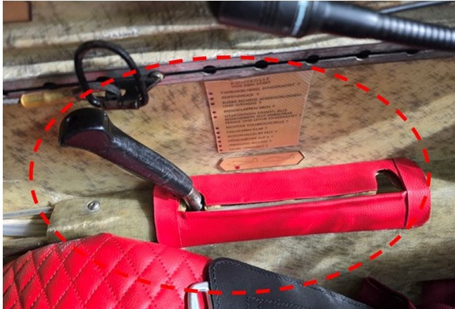
Abbildung 9 Fahrwerkhebel im ausgefahrenen Position
