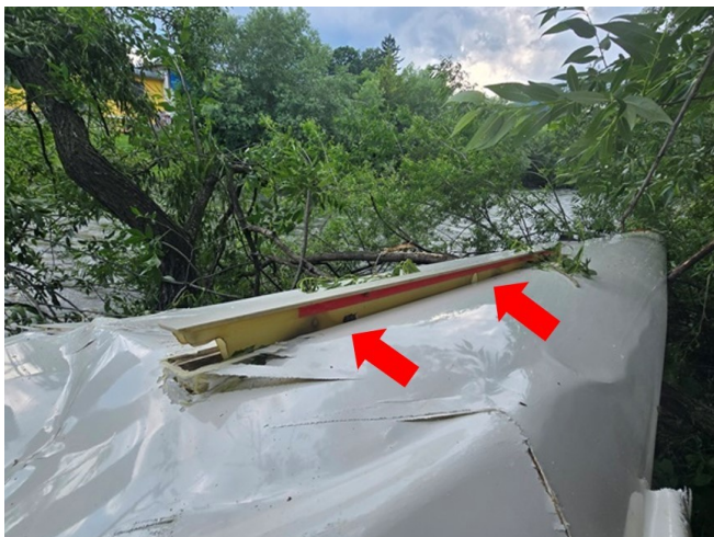
Abbildung 6 Linke Tragfläche und geöffnete Bremsklappe
