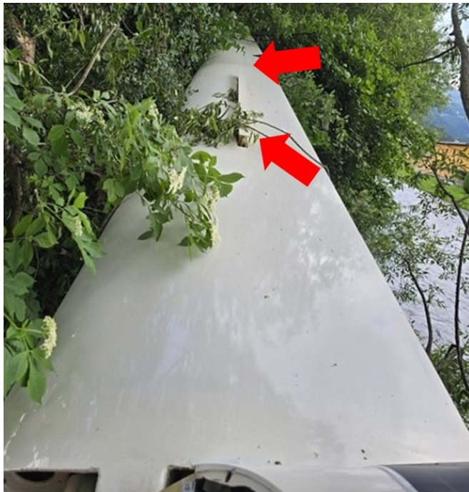
Abbildung 7 Rechte Tragfläche und geöffnete Bremsklappe
